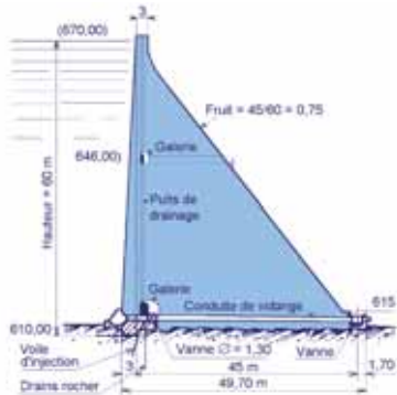
Coupe type d'un barrage-poids
