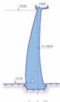
Coupe type d'un barrage-voûte
