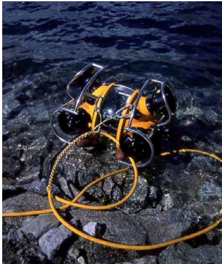
Robot subaquatique filoguidé permettant l'inspection par voie indirecte des parties immergées de la retenue - BETCGB
