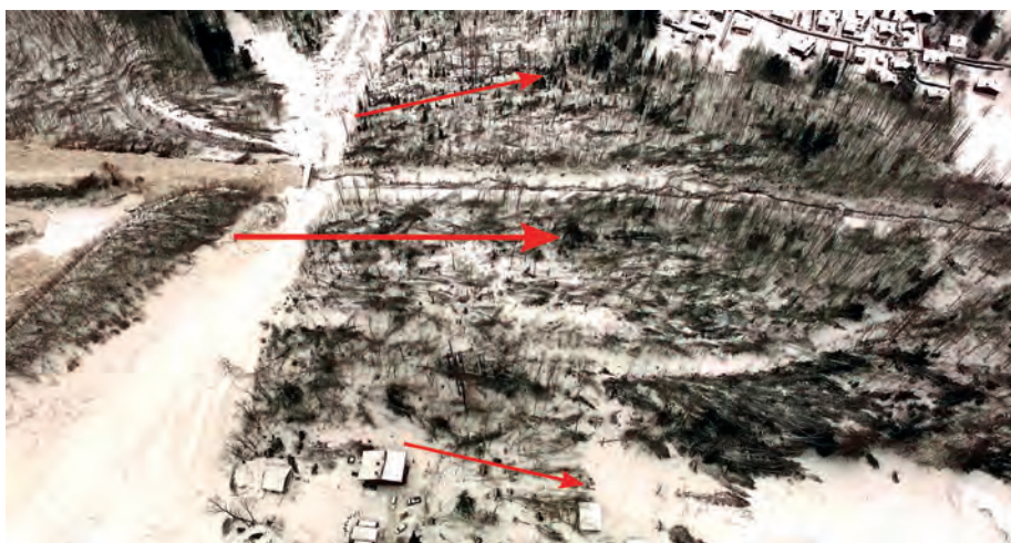
Figure 2 : exemples de dégâts causés par l'aérosol sur la forêt, sur les rives droite et gauche en amont du paravalanche (photographie du haut) et au niveau des habitations en aval du paravalanche (photographie du bas). Les flèches en rouge indiquent les directions principales de l'aérosol. ©Mairie Les Houches
