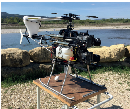
Drone avant vol de mesure sur digues © Marion Tanguy - IFSTTAR
