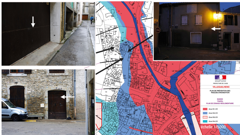
Extrait du PPR de Villegailhenc (Aude) approuvé par arrêté préfectoral le 22 décembre 2003 et modifié par arrêté préfectoral le 7 août 2013. Les flèches blanches sur les photos représentent la hauteur de la crue sur des habitations situées en zone bleue et blanche.
