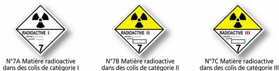
Figure 18 - Etiquetage des colis de produits radioactive selon catégorie.
