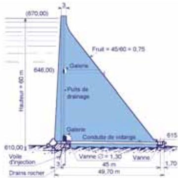
Coupe type d'un barrage-poids
