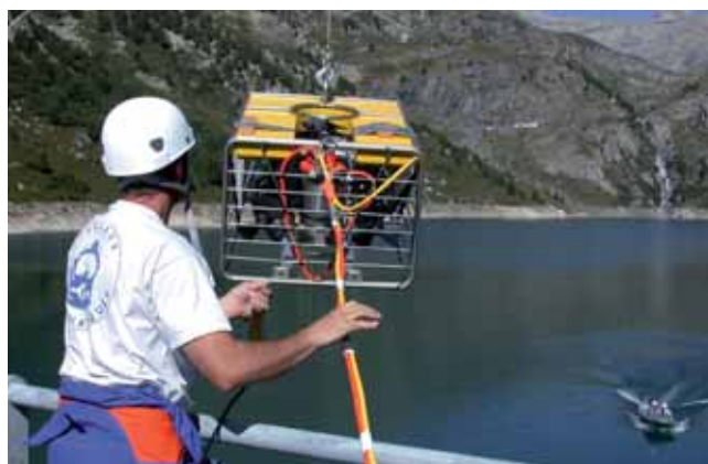
Mise à l'eau d'un robot subaquatique de contrôle - EDF
