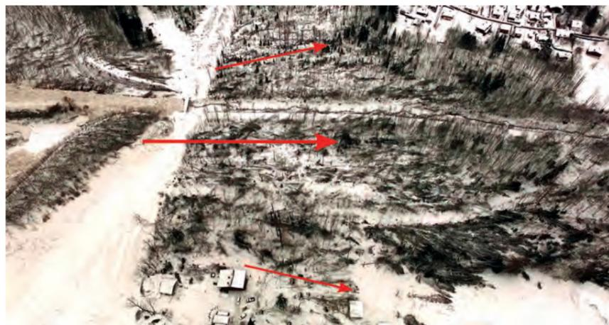
Figure 2 : exemples de dégâts causés par l'aérosol sur la forêt, sur les rives droite et gauche en amont du paravalanche (photographie du haut) et au niveau des habitations en aval du paravalanche (photographie du bas). Les flèches en rouge indiquent les directions principales de l'aérosol. ©Mairie Les Houches
