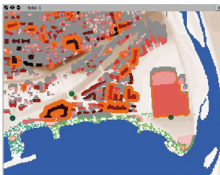
figure 2 : Interface de simulation du modèle STEP de Saint-Laurent-du-Var : la mer avant le tsunami (en bleu), les constructions en fonction de leur hauteur (du rose au rouge foncé), effondrement suite au séisme (en orange), zones refuges (cibles vertes) et leur zone de non-visibilité (en gris) et la population à évacuer (en vert) © Odile Plattard, 2018.
